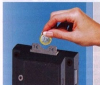
Der Gast belegt den Schrank seiner Wahl, indem er die Pfandmünze wie gewohnt in das Schloss einsteckt, einen PIN-Code eingibt und die Fachtür per Drehknopf verriegelt. Zum Entriegeln des Schrankes genügt die Eingabe des PIN-Codes, und die Pfandmünze kann wieder entnommen werden.
